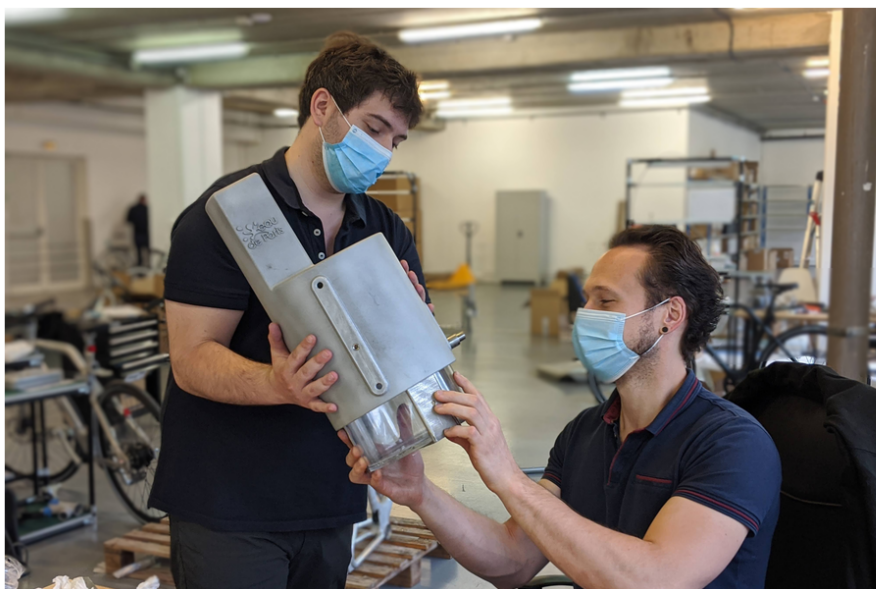
Le distributeur de savon, en aluminium et polycarbonate, lors de son assemblage dans la micro-usine Kickmaker.
